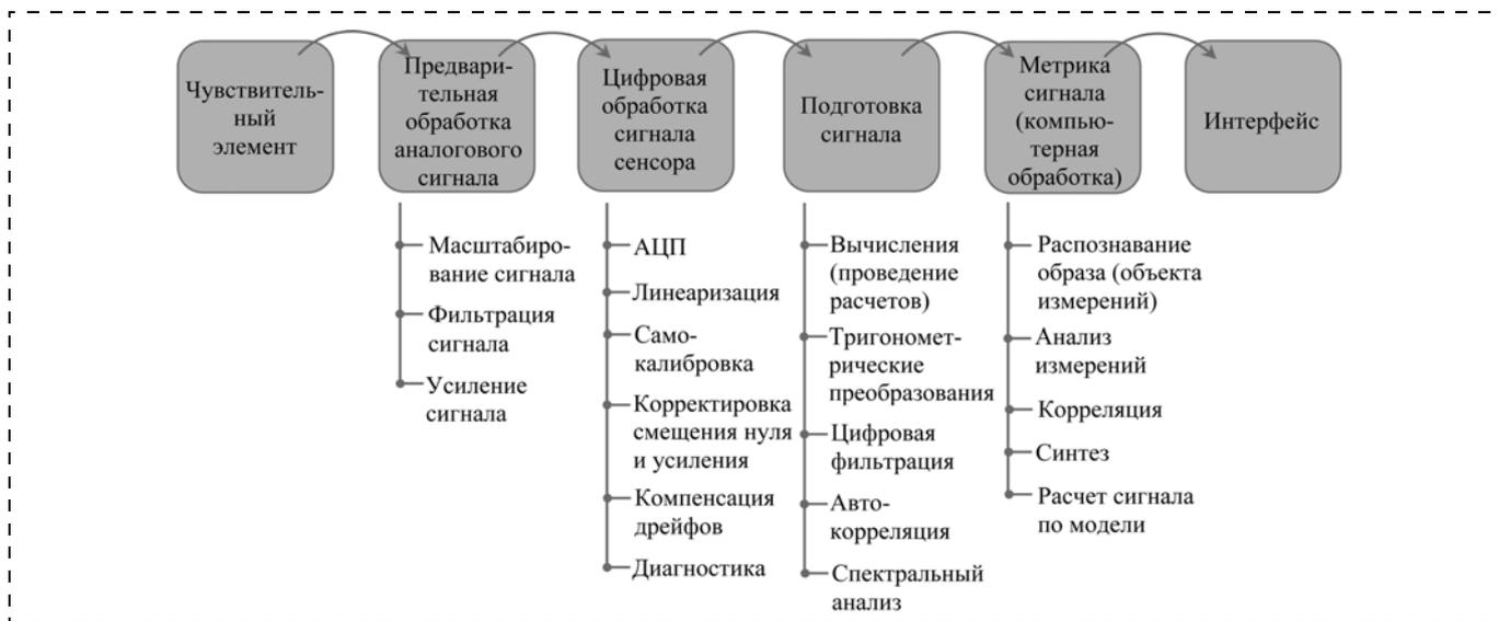
Рис. 1. Функциональные блоки датчика
