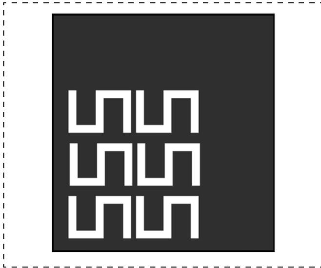
Рис. 13. Вид S-образных щелей в металлизации диэлектрика
