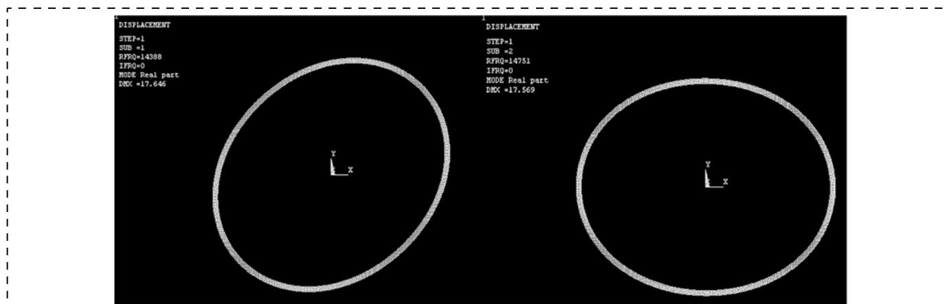
Рис. 4. Расщепление собственных частот второй моды собственных колебаний
