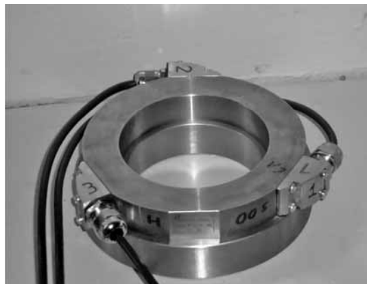
Рис. 1. Акустоэлектронный датчик силы СИШПАВ
