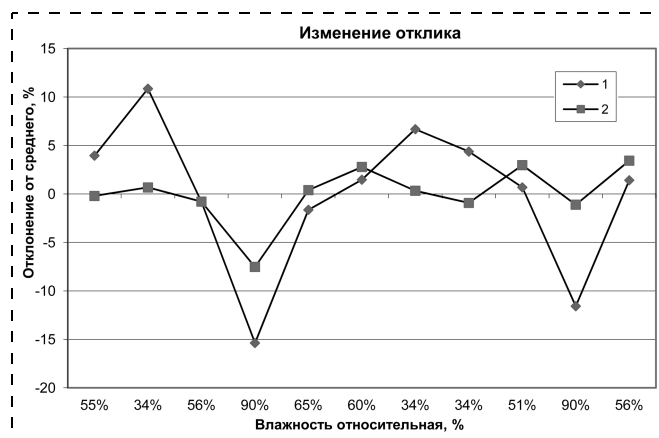
Рис. 9. Влияние относительной влажности на величину отклика сенсора на 100 ppm CO
