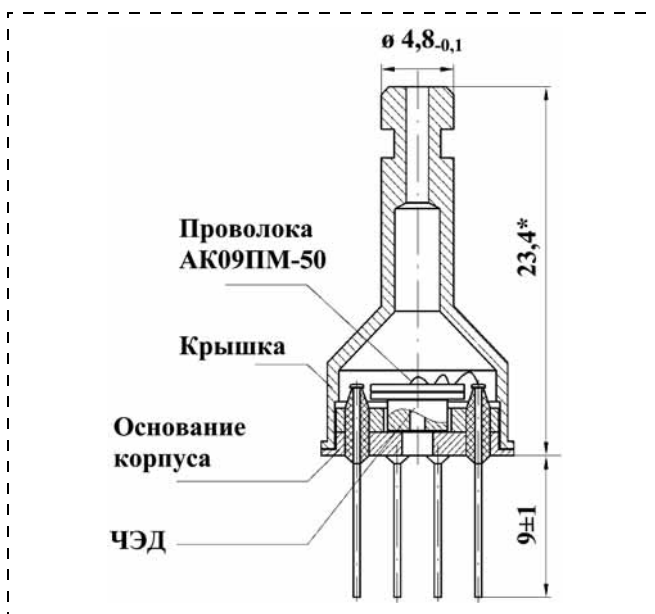
Рис. 4. Базовая конструкция датчика избыточного давления
