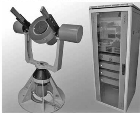
Рис. 11. Трехосный автоматизированный стенд
