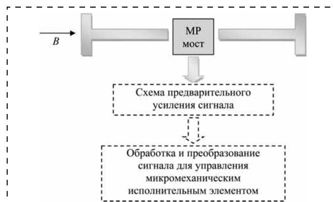
Рис. 10. Структурная схема приемника магнитного сигнала беспроводной МЭМС
