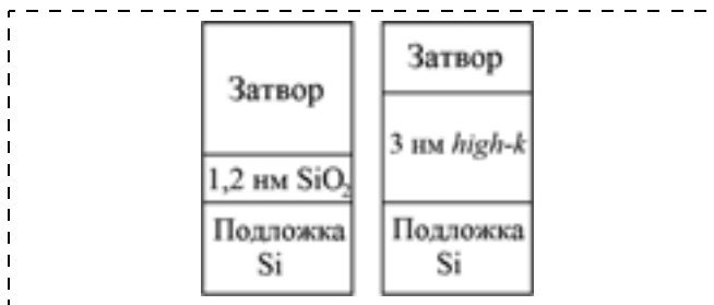
Рис. 4. Пример применения high-k диэлектрика в технологии 65 нм
