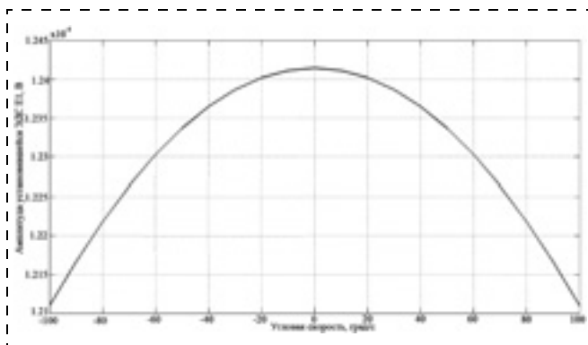
Рис. 10. Зависимость амплитуды установившегося сигнала E_1 от измеряемой угловой скорости
