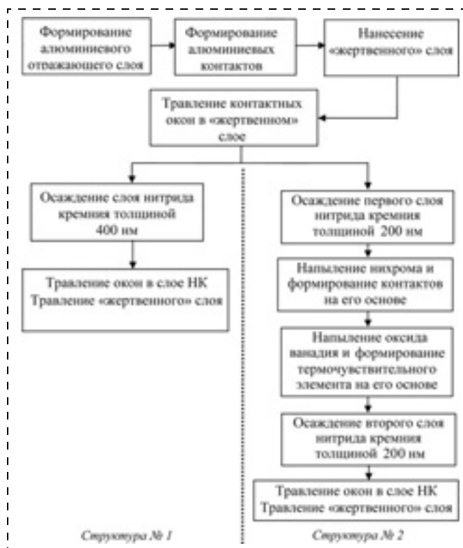
Рис. 1. Технологические схемы изготовления микромостиковых структур
