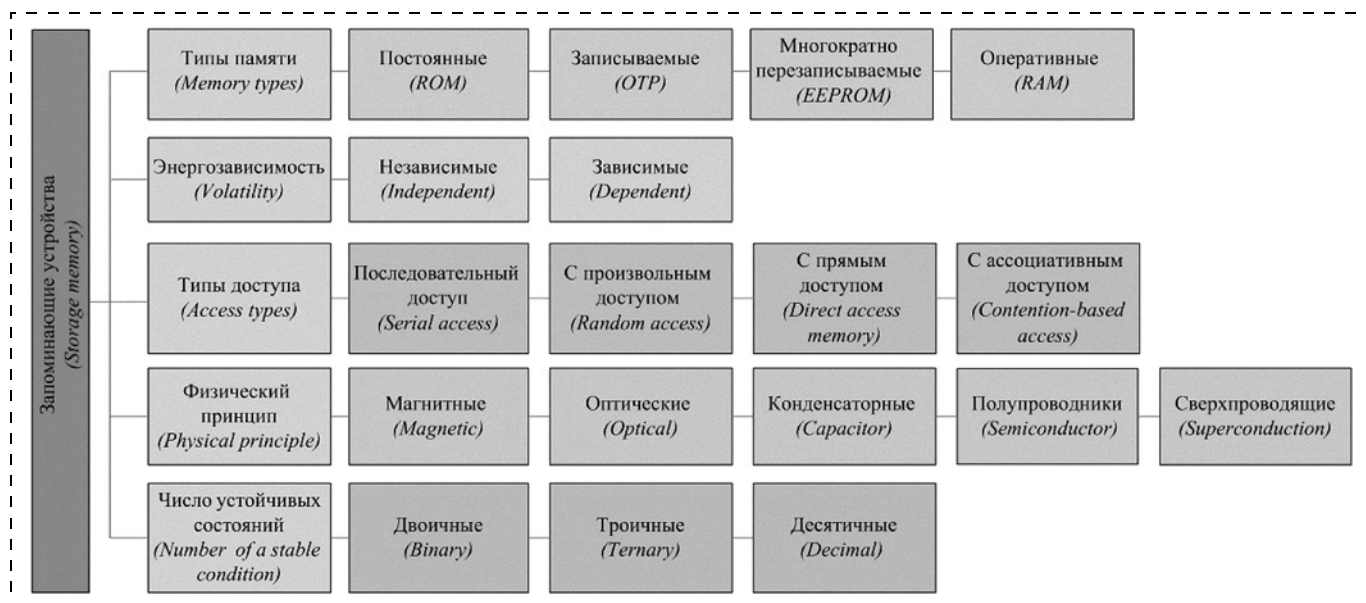
Рис. 11. Классификация запоминающих устройств
