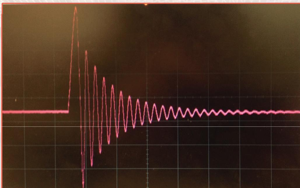
**Рис. 2. Зависимость выходного напряжения от времени: время затухания сигнала
