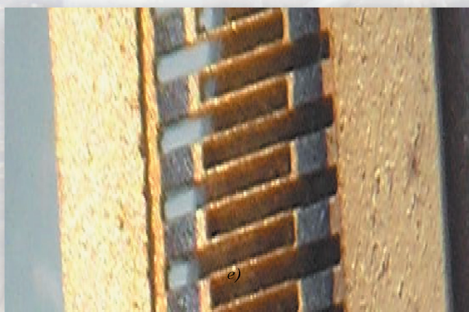
Рис. 4. Фрагмент планарной монолитной ЗС из поликристаллического алмаза Fig. 4. A fragment of a planar monolithic slow-wave structure from a polycrystalline diamond
