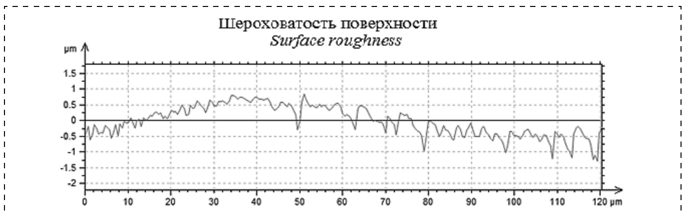
Рис. 3. Профиль боковых стенок после травления Fig. 3. Profile of the sidewalls after etching
