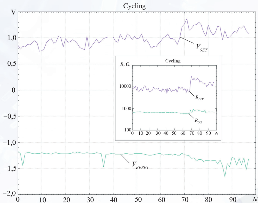
Рис. 5. Динамика ключевых параметров мемристивного элемента. Во вклейке показан временной ряд ( R_{ON} , R_{OFF} )
