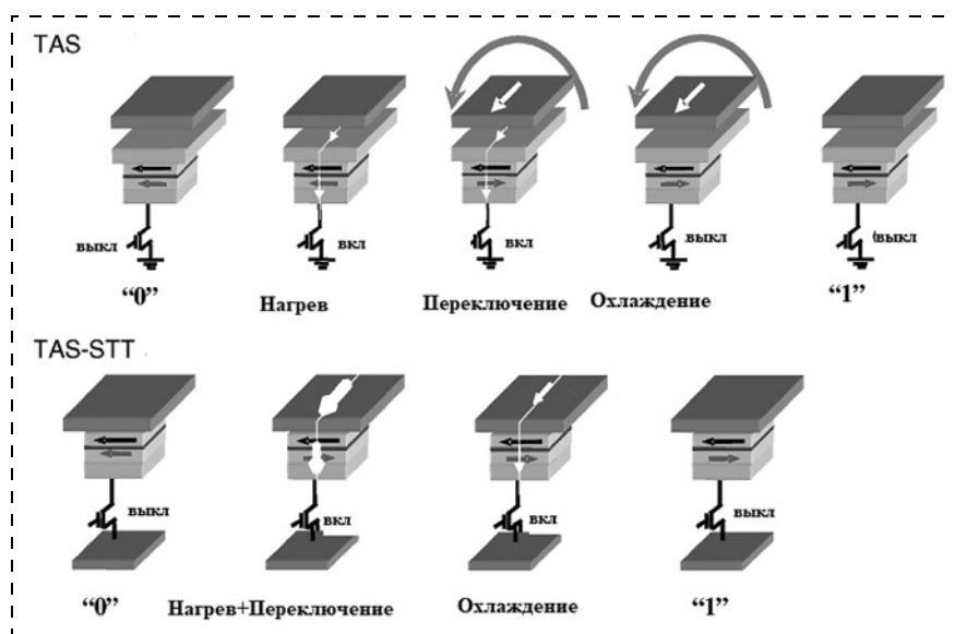
Рис. 9. Принцип записи TA-MRAM импульсом магнитного поля и TA-STT-MRAM поляризованным током [8]
