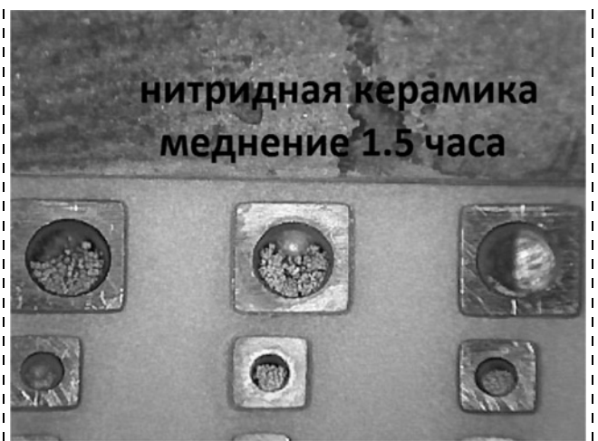
Рис. 6. Этап гальванического заравнивания "колодца" переходного отверстия
