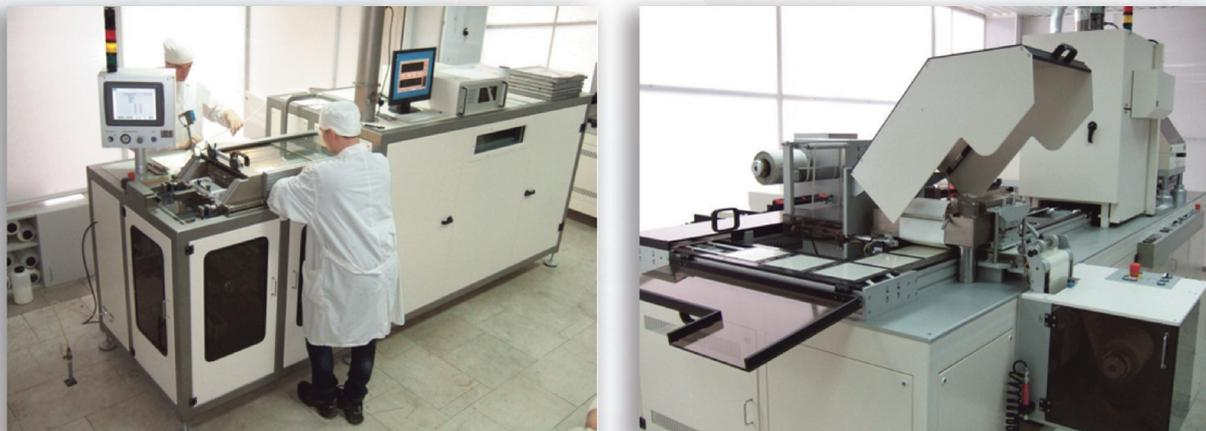
Рис. 1. Линия изготовления пьезокерамической пленки
