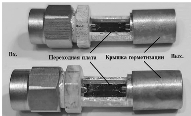
Рис. 7. Фотографии изготовленных экспериментальных образцов емкостных РЧ МЭМС-переключателей в специализированном РЧ корпусе с коаксиальными выводами и открытой крышкой герметизации
