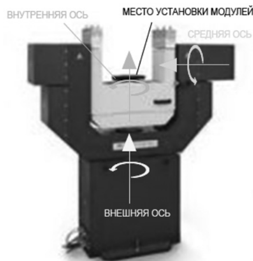
Рис. 5. Фотография типового трехосного стенда с указанием осей поворотного стола
