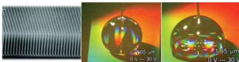
Рис. 1.14. «Нанотрава» и электролит — основные составляющие нанобатарейки
